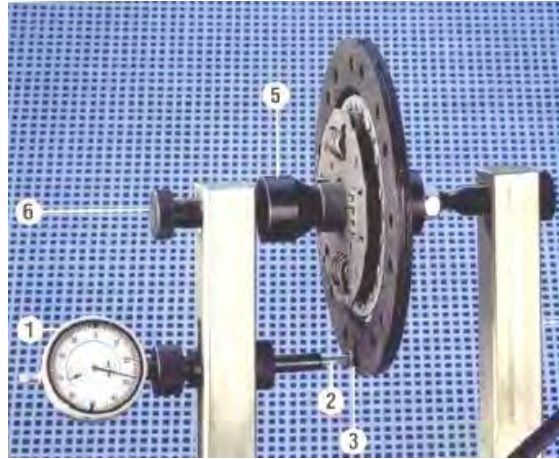
Abb. 229. Kontrolle des Rundlaufs der Arbeitsfläche der angetriebenen Scheibe.
