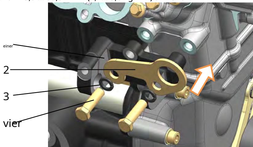
Abb. 182. Montage der oberen Generatorhalterung mit der Vorderseite Motorheberhalterung:
