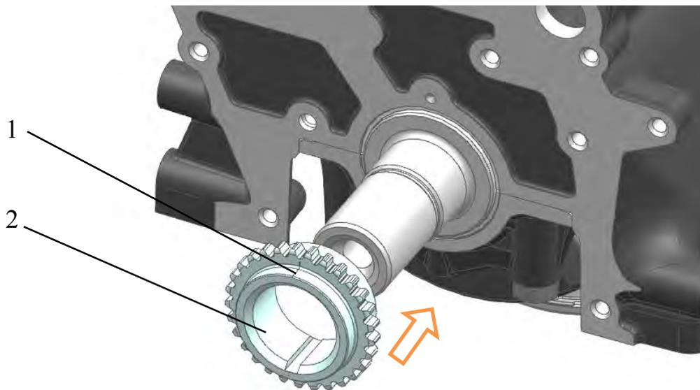
Рис.132. Установка звездочки:
