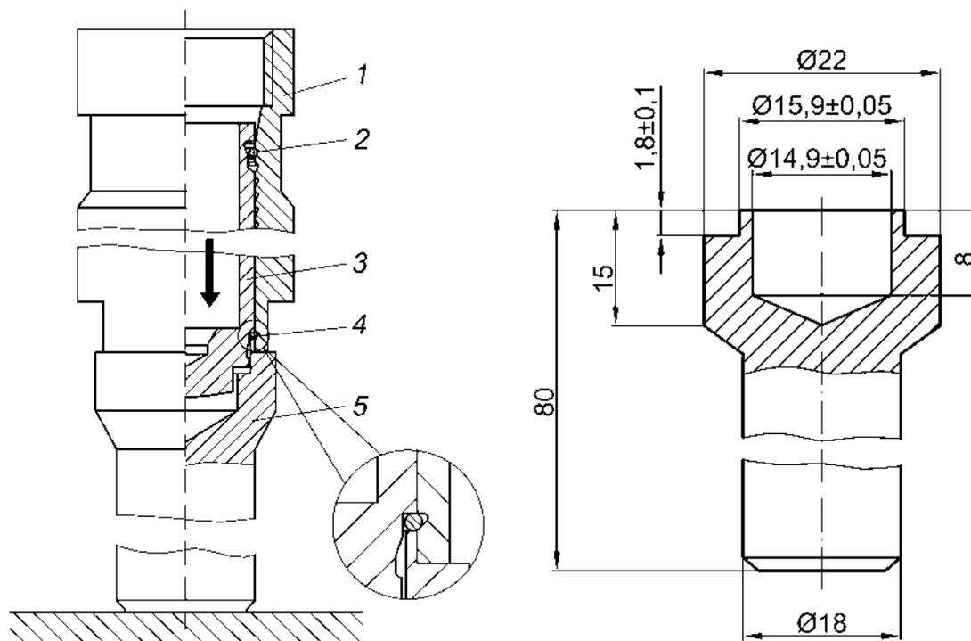
Рис.88. Сборка гидронатяжителя с помощью оправки:
