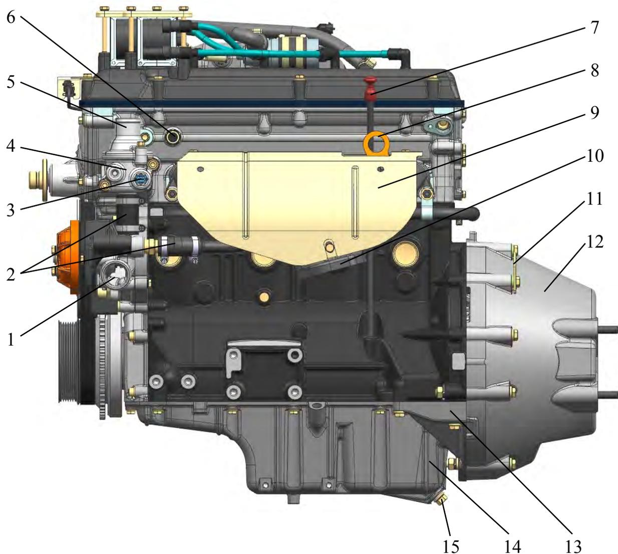
Рис.3. Вид двигателя слева с кронштейном насоса ГУР:
