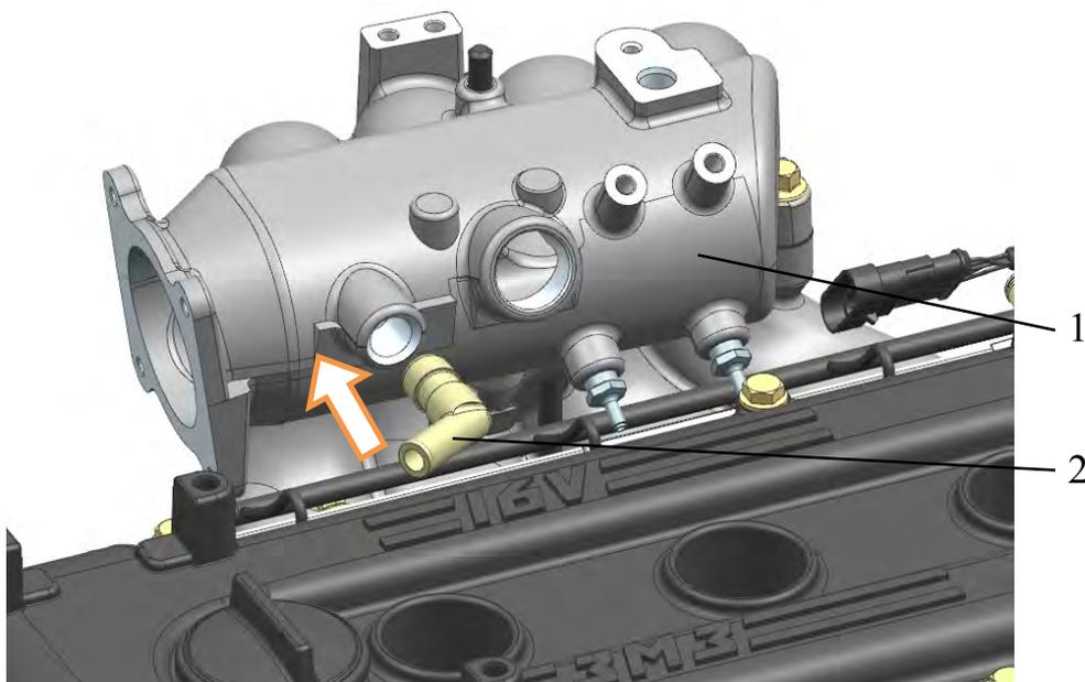
Рис.190. Установка в ресивер штуцера забора вакуума:
