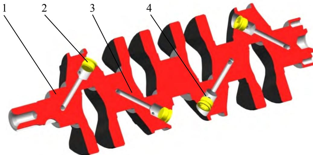
Рис.108. Пробки, каналы и грязеуловительные полости коленчатого вала:
