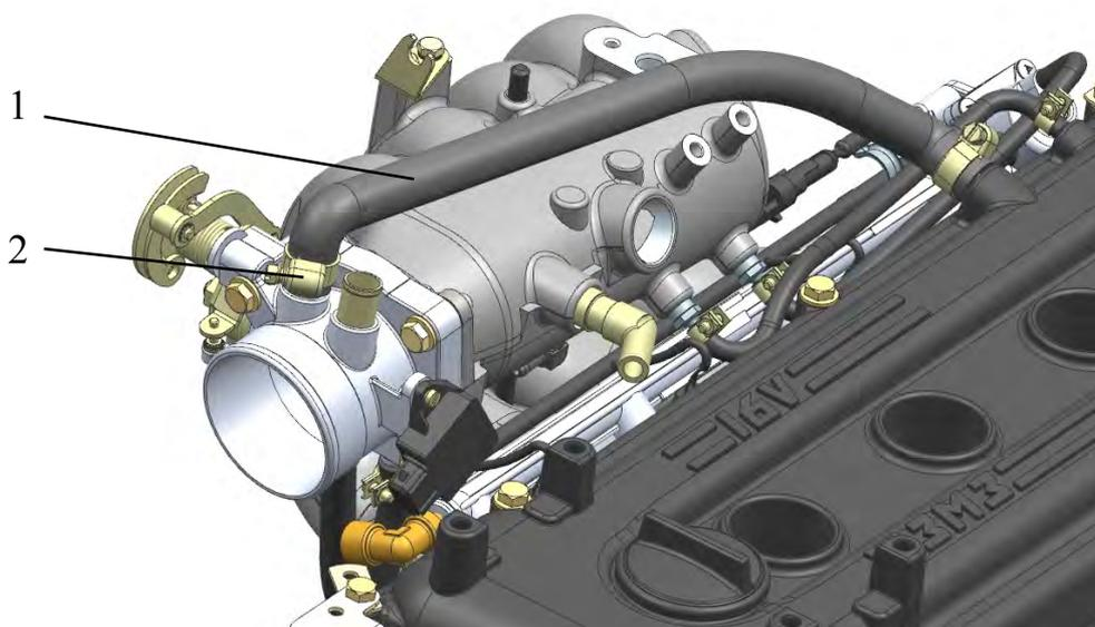
Рис.203. Установка шланга основной ветви вентиляции картера:
