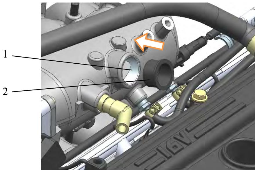
Рис.205. Установка уплотнительного кольца патрубка регулятора холостого хода:
