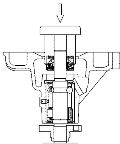
Рис.96. Запрессовка уплотнения водяного насоса
