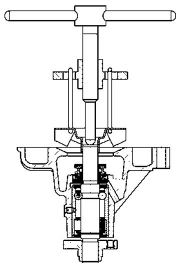
Рис.91. Снятие крыльчатки
