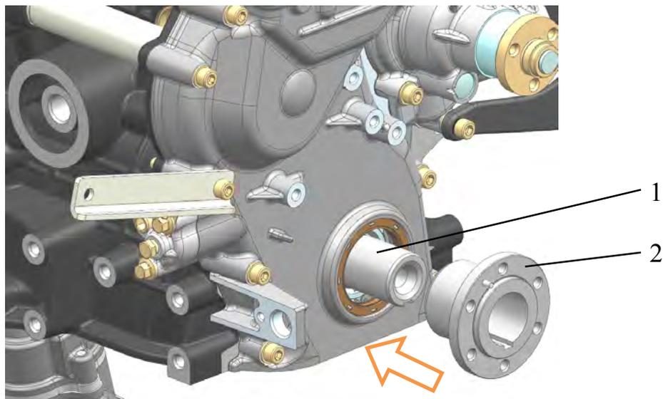
Рис.160. Установка ступицы шкива коленчатого вала:
