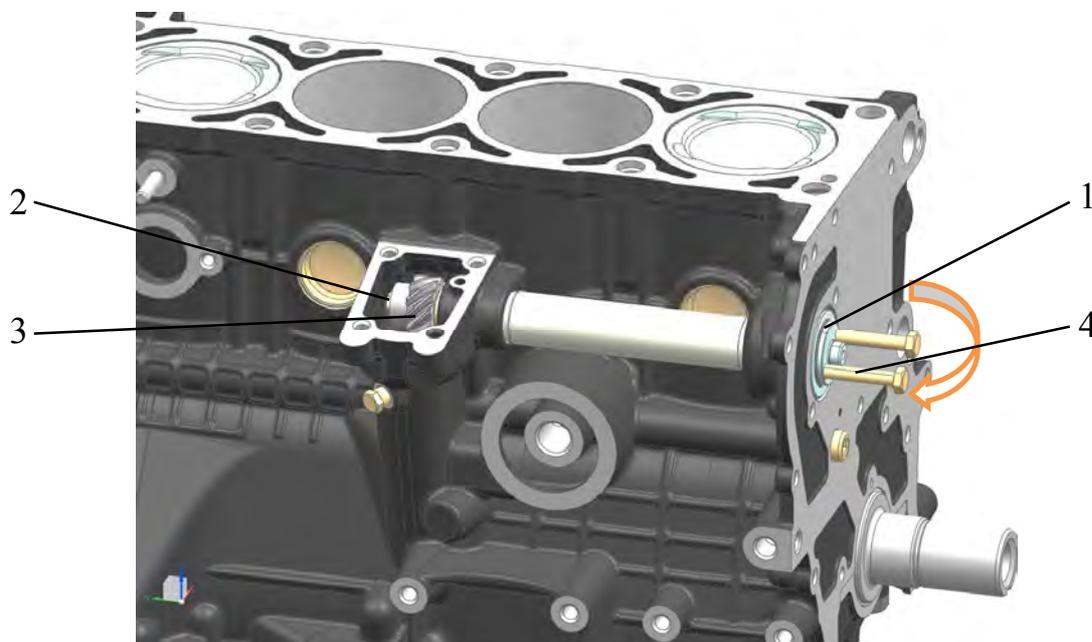
Рис.127. Установка шестерни с гайкой:
