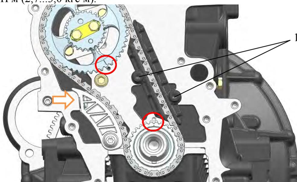
Рис.140. Проверка правильности установки звездочек:
