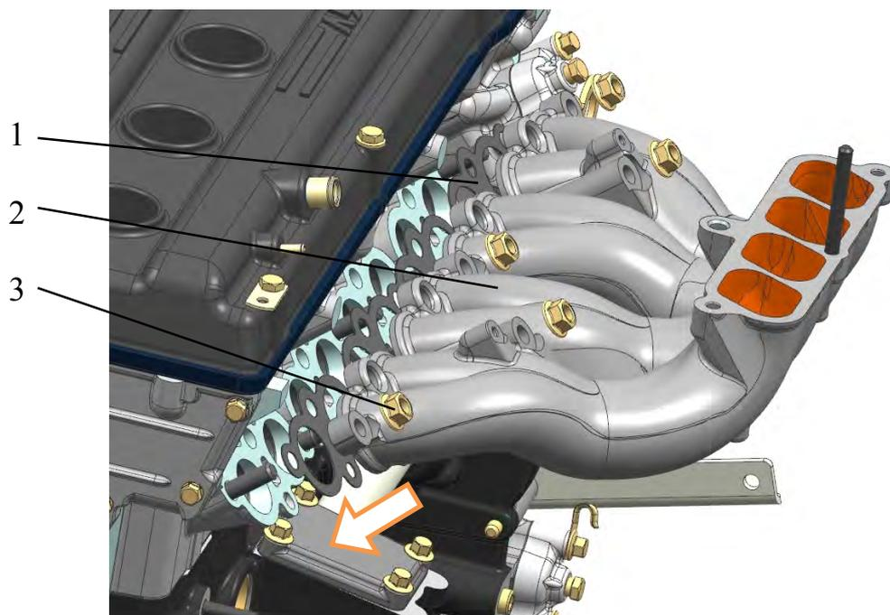
Рис.185. Установка впускной трубы:
