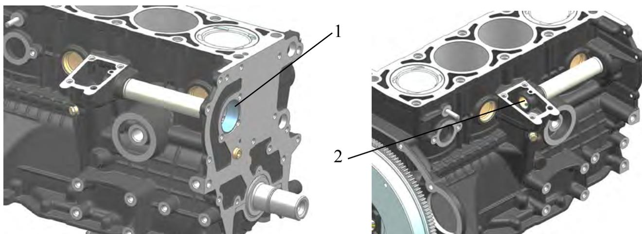
Рис.124. Втулки промежуточного вала:
