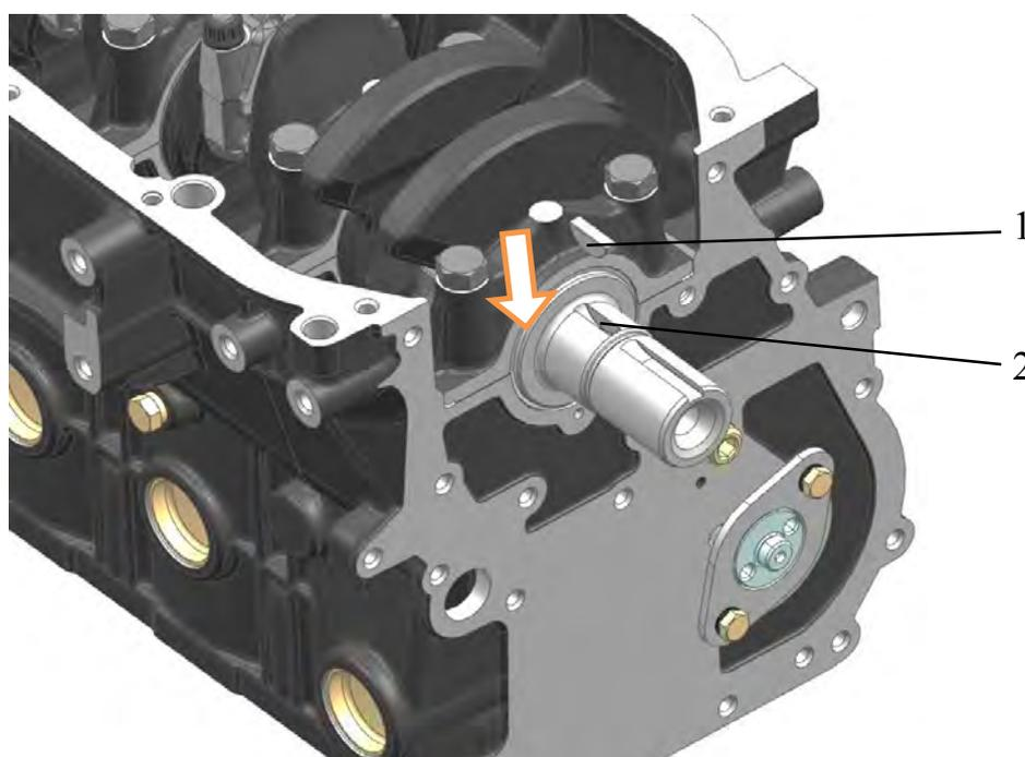
Рис.131. Установка шпонки звездочки:
