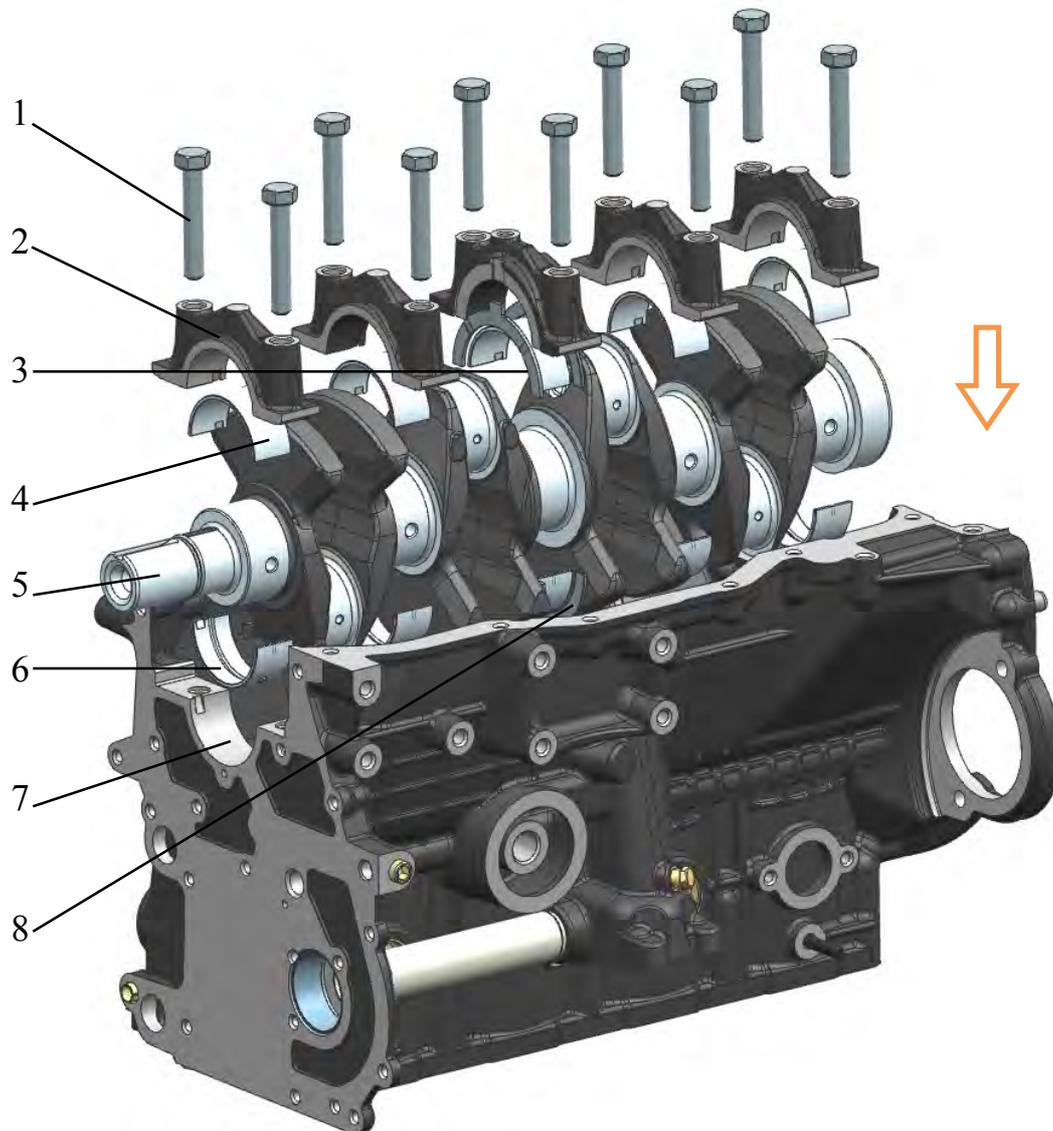
Рис.109. Установка коленчатого вала:
