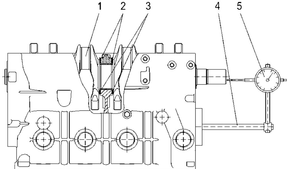
Рис.110. Проверка осевого зазора коленчатого вала:
