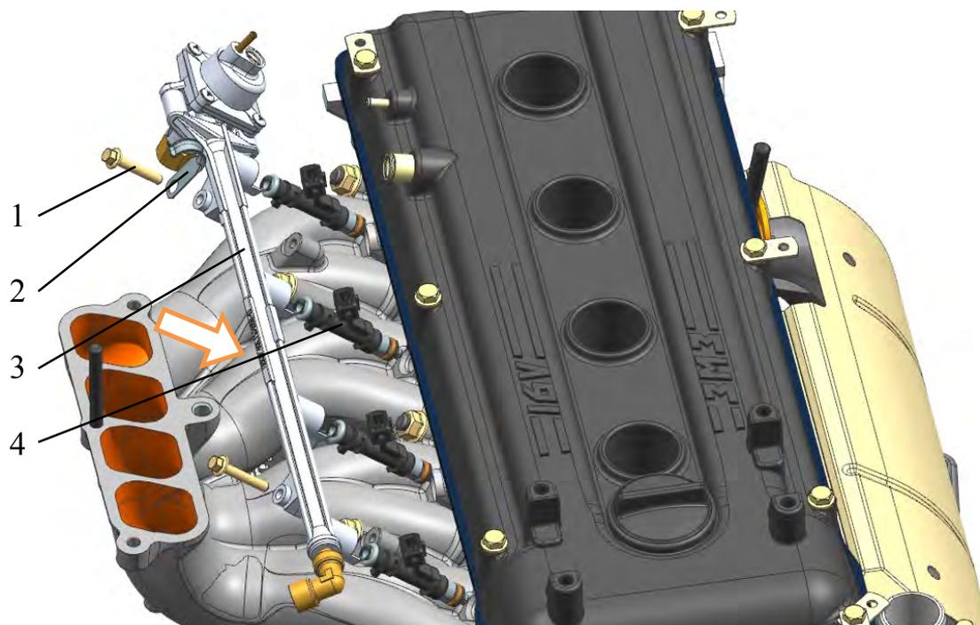
Рис.186. Установка топливопровода с форсунками:
