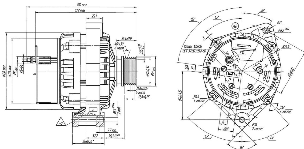
Рис.56. Габаритные размеры генератора 3212.3771000-10 ОАО «БАТЭ»
