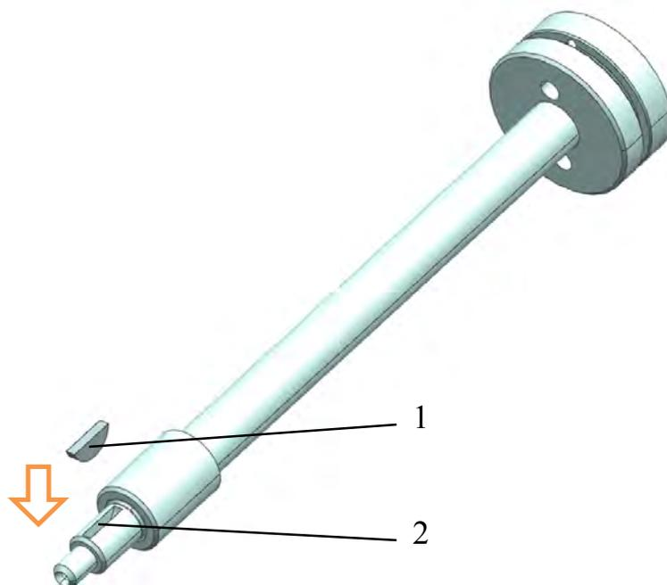
Рис.125. Установка шпонки в промежуточный вал:
