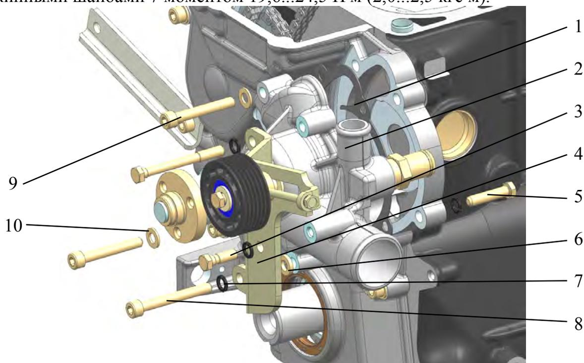
Рис.147. Установка водяного насоса и кронштейна натяжного ролика ремня привода вентилятора:
