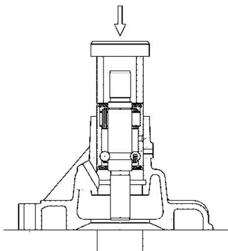
Рис.95. Запрессовка подшипника с валиком
