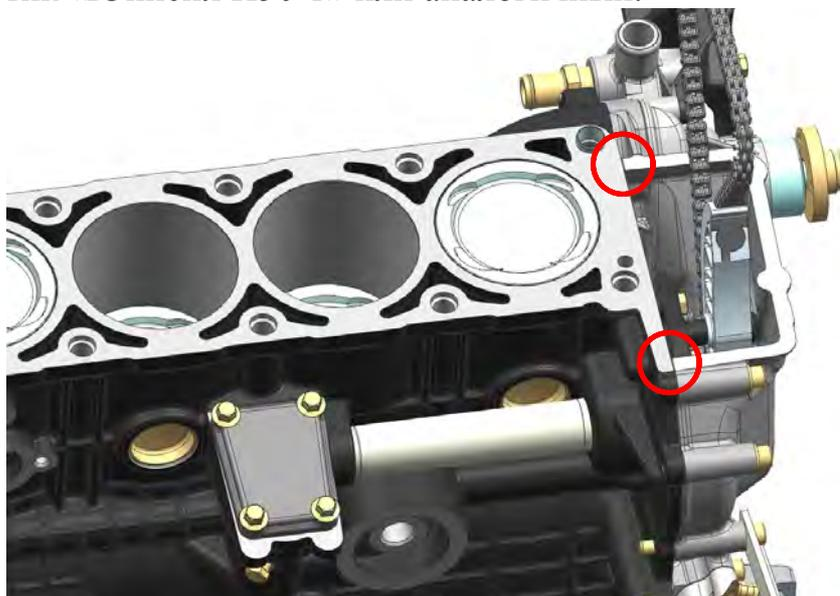
Рис.149. Места среза прокладок и нанесения герметика
