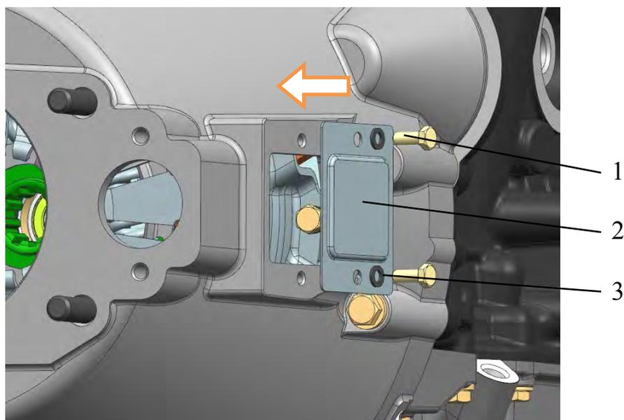
Рис.195. Установка крышки люка картера сцепления:
