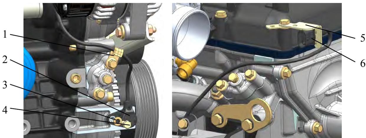
Рис.216. Установка датчика синхронизации:
