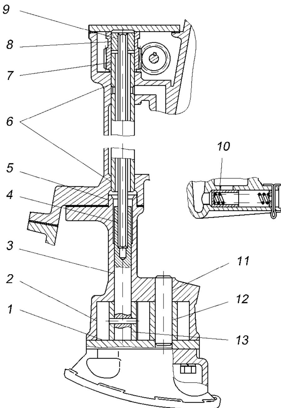
Рис.237. Масляный насос, редукционный клапан и привод масляного насоса
