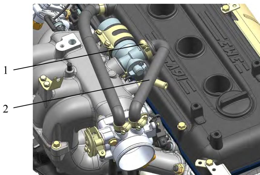
Рис.207. Установка шланга регулятора холостого хода:
