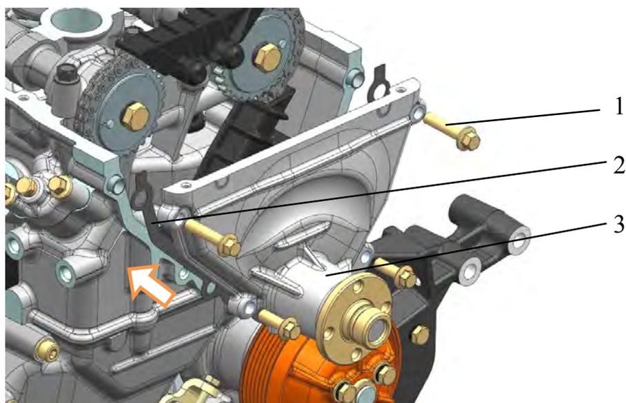
Рис.172. Установка передней крышки головки цилиндров:
