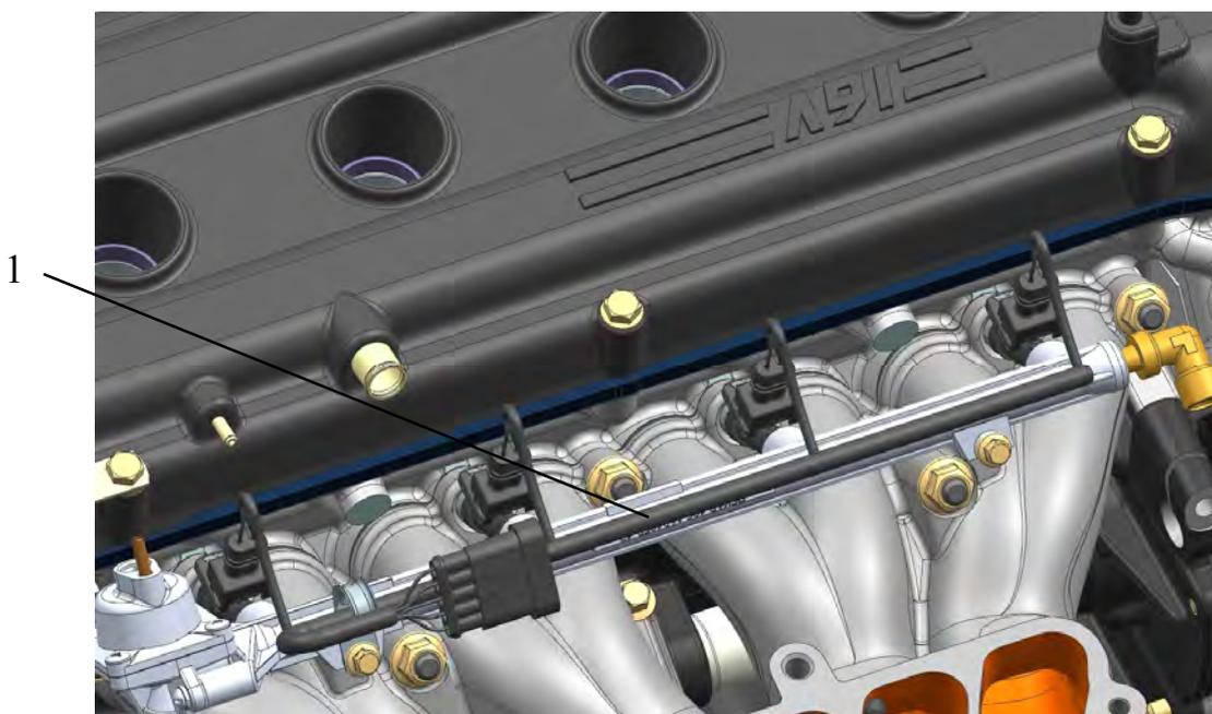
Рис.187. Установка жгута проводов форсунок:
