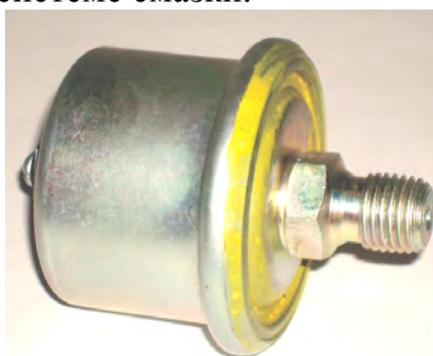
Рис.62. Датчик указателя давления масла
