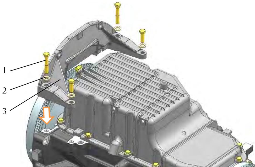
Рис.168. Установка усилителя картера сцепления:
