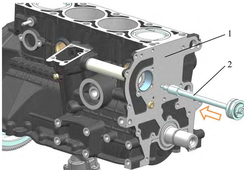
Рис.126. Установка промежуточного вала:
