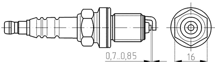
Рис.49. Свеча зажигания
