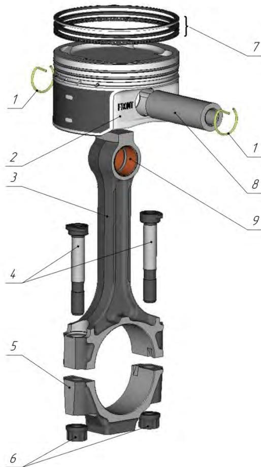
Рис.17. Поршень и шатун:
