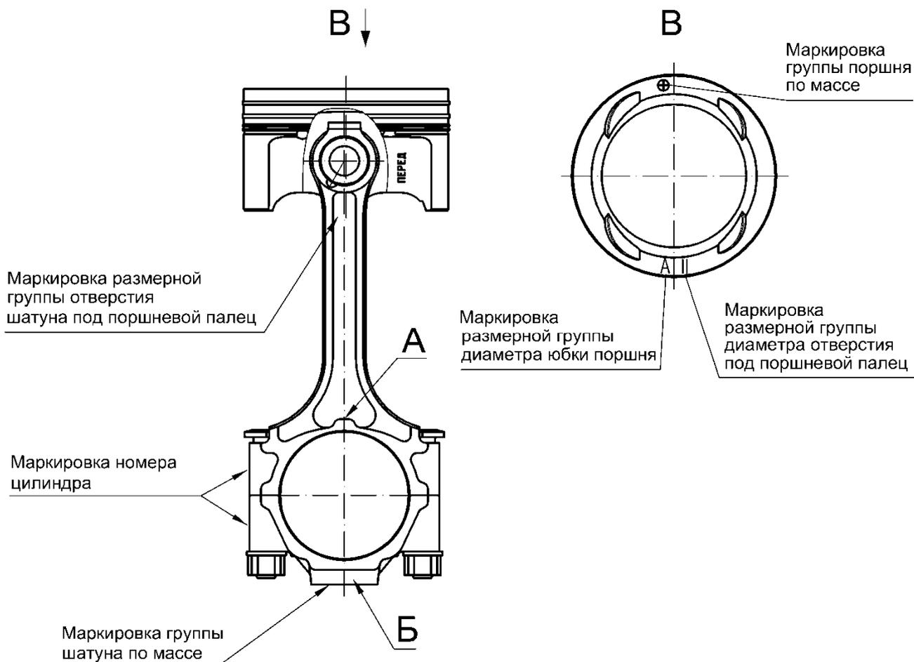
Рис.117. Маркировка шатуна и поршня
