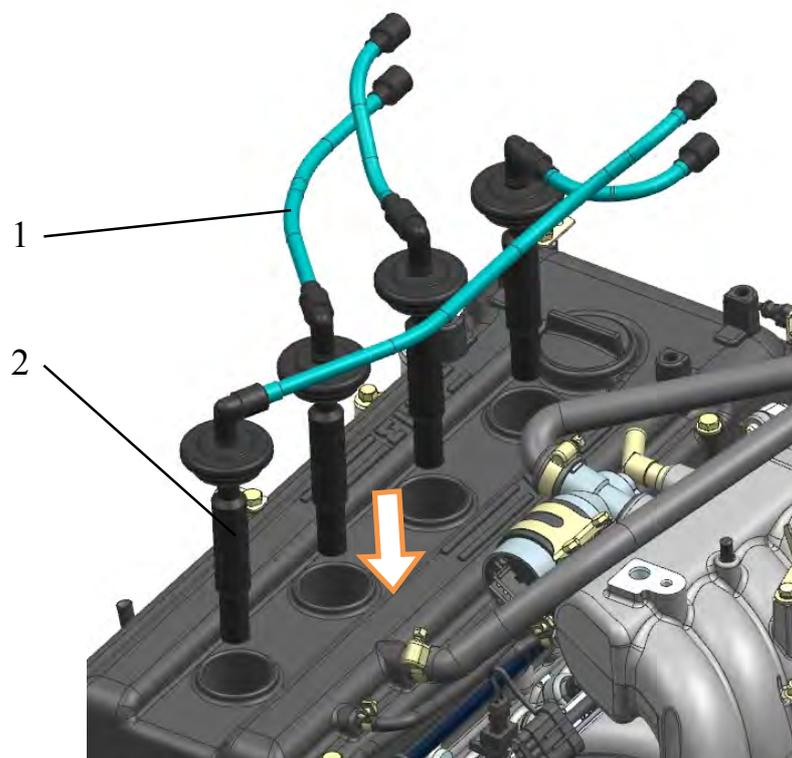
Рис.219. Установка высоковольтных проводов с наконечниками:
