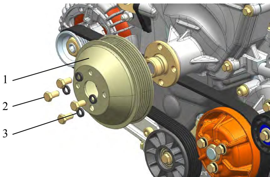
Рис.213. Установка шкива вентилятора:
