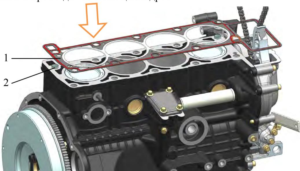
Рис.150. Установка прокладки головки цилиндров:
