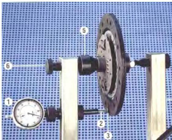
Рис.231. Проверка биения рабочей поверхности ведомого диска.
