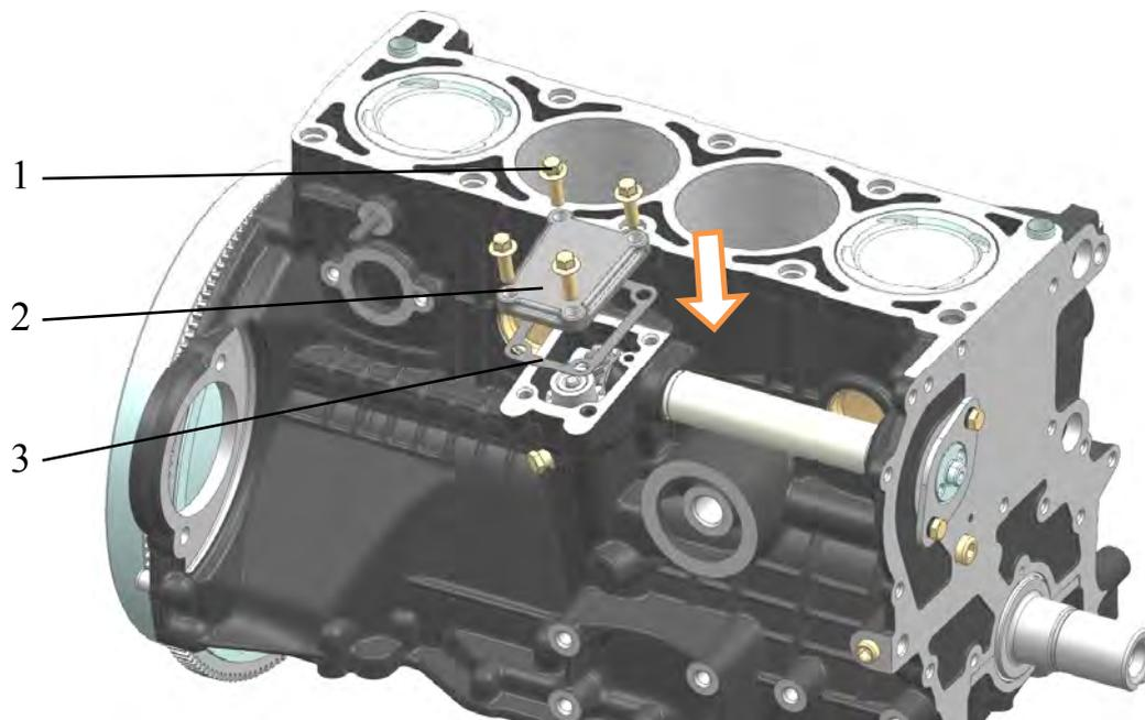
Рис.130. Установка крышки привода:
