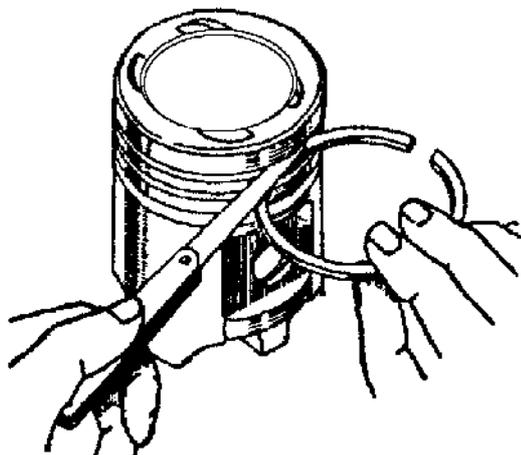
Рис.119. Проверка бокового зазора между поршневым кольцом и канавкой в поршне
