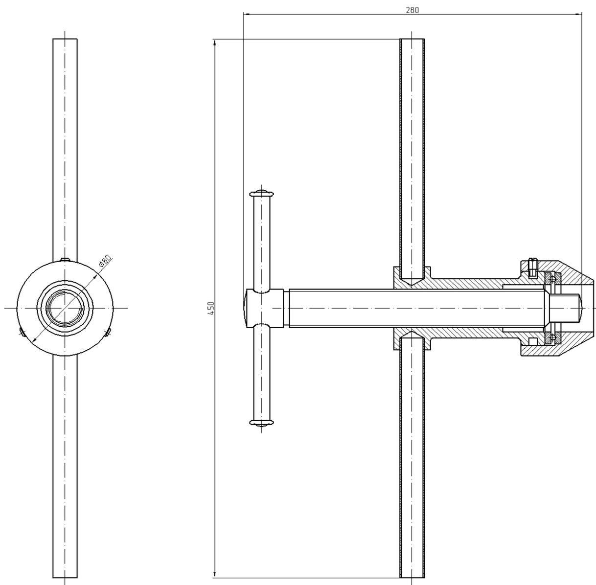
Рис.240. ЗМ 7823-4291-01, Приспособление для напесовки звездочки и ступицы на коленчатый вал
