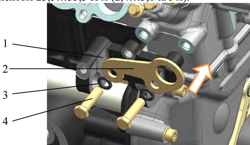
Рис.184. Установка верхнего кронштейна генератора с передним кронштейном подъёма двигателя:
