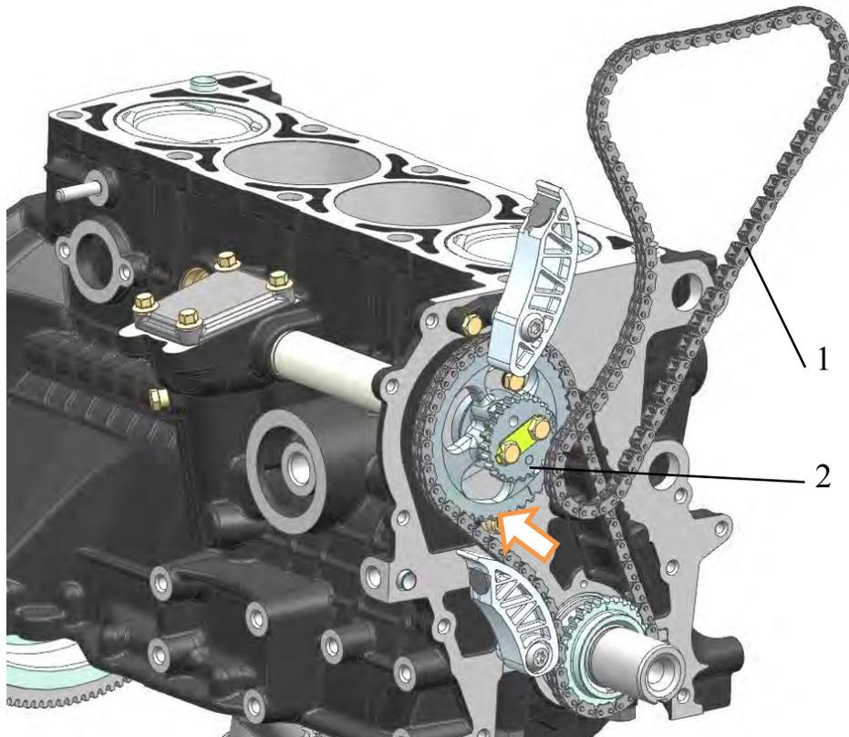
Рис.143. Установка верхней цепи на ведущую звездочку:
