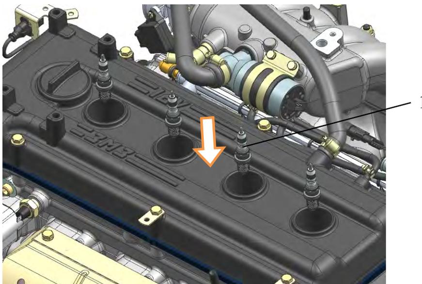
Рис.218. Установка свечей зажигания:
