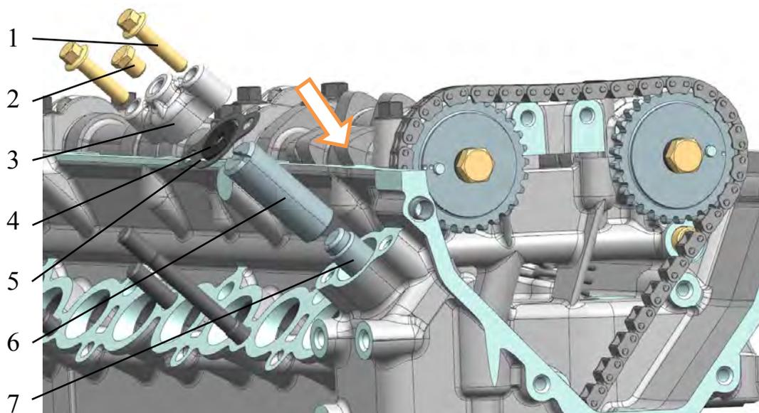
Рис.158. Установка гидронатяжителя верхней цепи:
