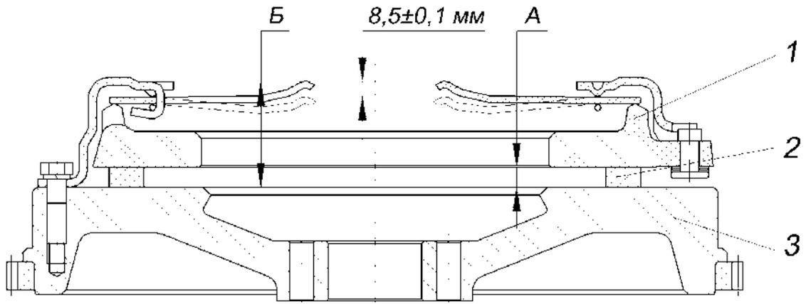
Рис.232. Регулировка концов лепестков и проверка нажимного диска сцепления:
