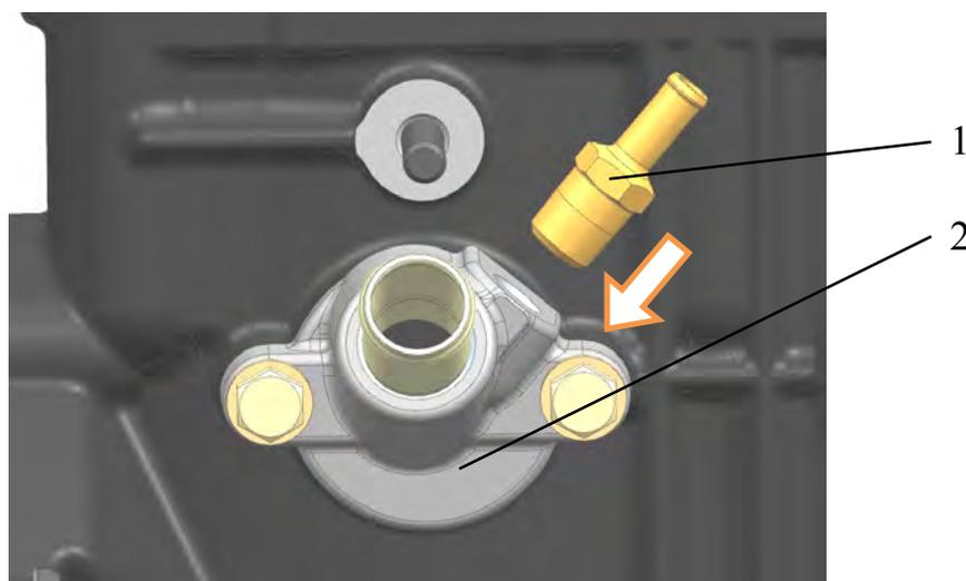
Рис.192. Установка штуцера патрубка отопителя:
