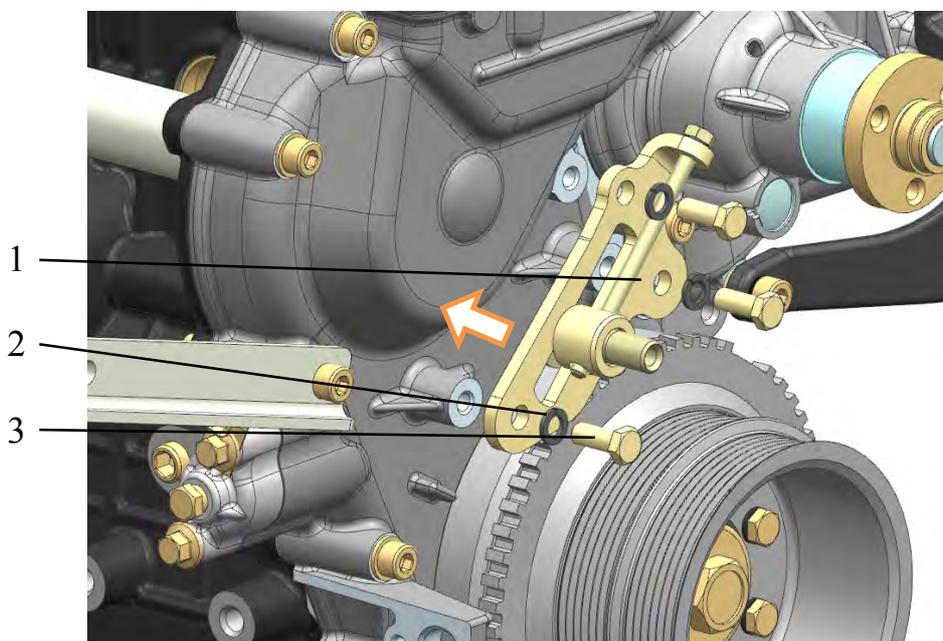
Рис.169. Установка кронштейна натяжного ролика ремня привода водяного насоса и генератора:
