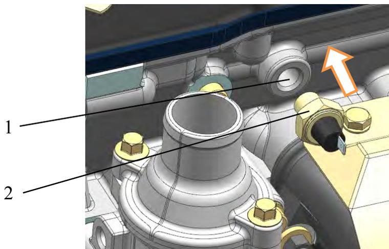
Рис.209. Установка датчика аварийного давления масла:
