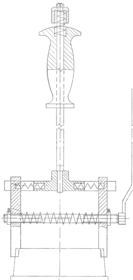
Рис.255. ЗМ 7814-5146, Съёмник для снятия крышек коренных подшипников
