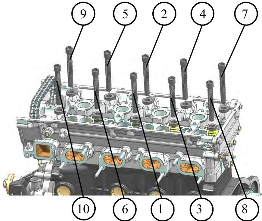
Рис.151. Последовательность затяжки болтов головки цилиндров двигателей с мягкой (из асбостального листа) прокладкой головки цилиндров
