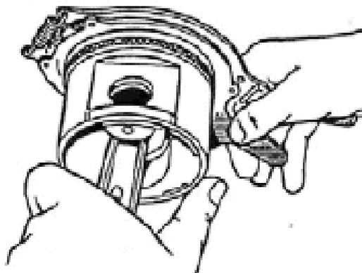
Рис.120. Установка поршневых колец на поршень
