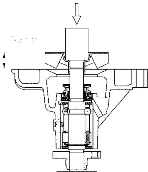
Рис.99. Напрессовка крыльчатки
