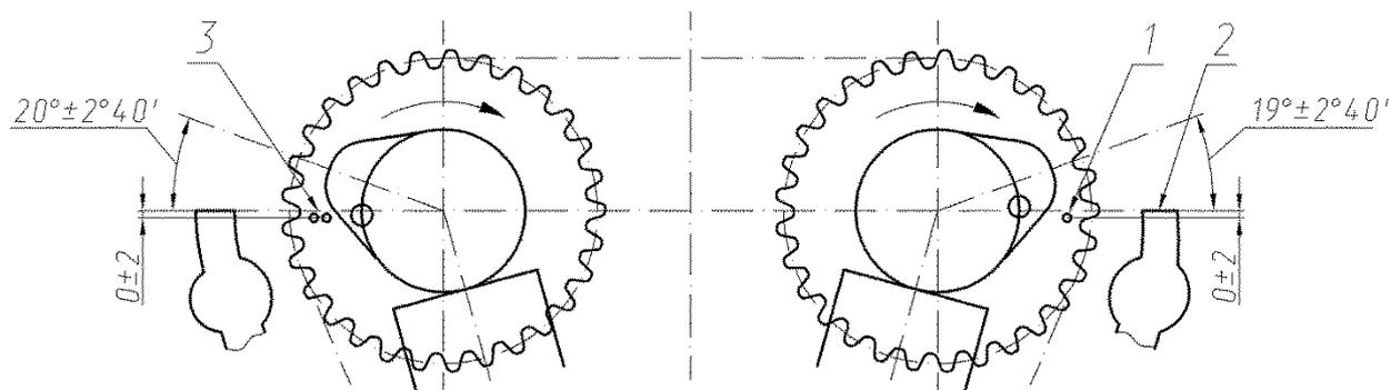
Рис.85. Схема положения распределительных валов при положении поршня первого цилиндра в ВМТ такта сжатия:
