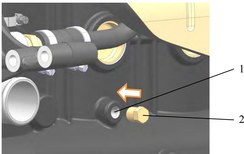
Рис.180. Установка сливной пробки:
