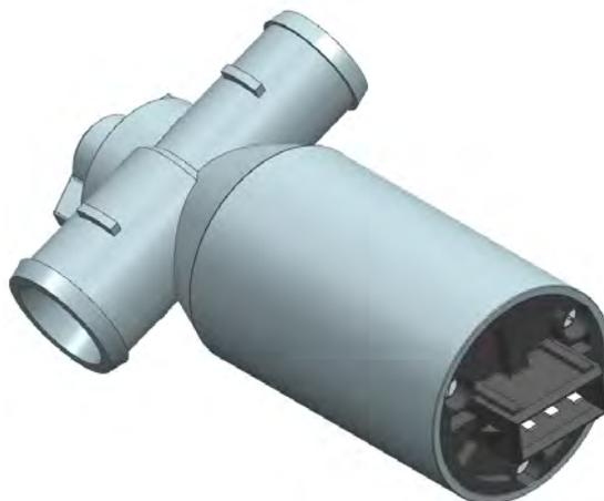
Рис.43. Регулятор холостого хода
