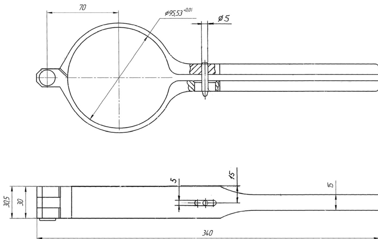
Рис.244. ЗМ 7820-4517, Оправка для сжатия поршневых колец  $\varnothing 95,5$  мм
