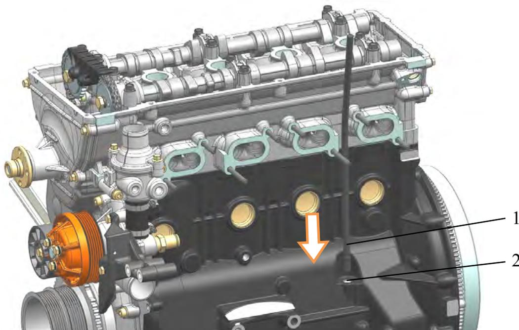
Рис.175. Установка трубки указателя уровня масла:
