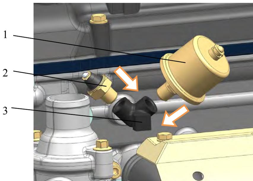
Рис.208. Установка датчиков давления масла:
