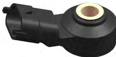
Рис.55. Датчик детонации
