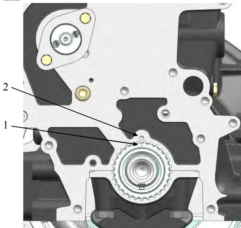
Рис.133. Метки блока цилиндров и звездочки коленчатого вала:
