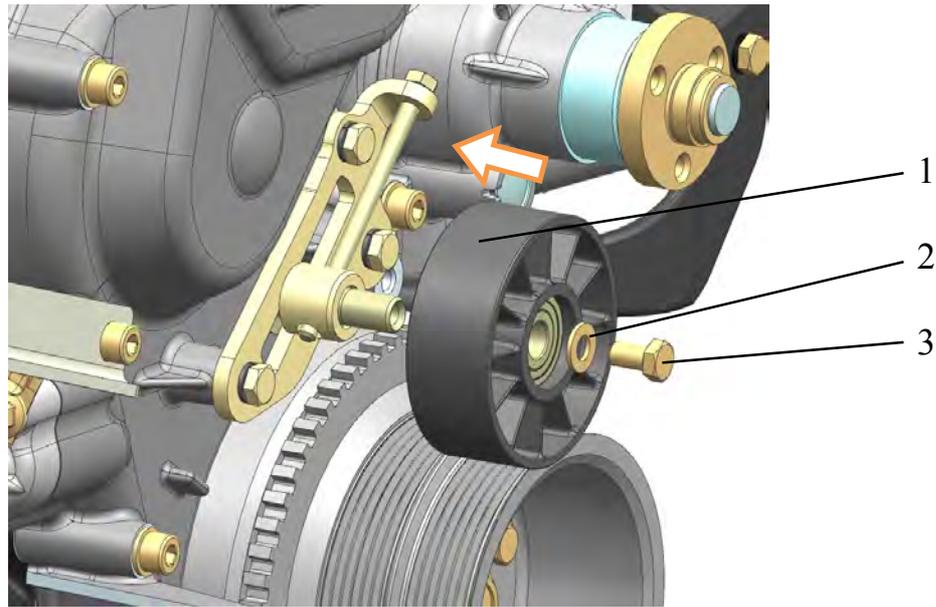
Рис.170. Установка натяжного ролика ремня привода водяного насоса и генератора:
