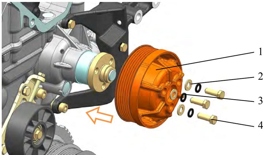
Рис.171. Установка шкива водяного насоса:
