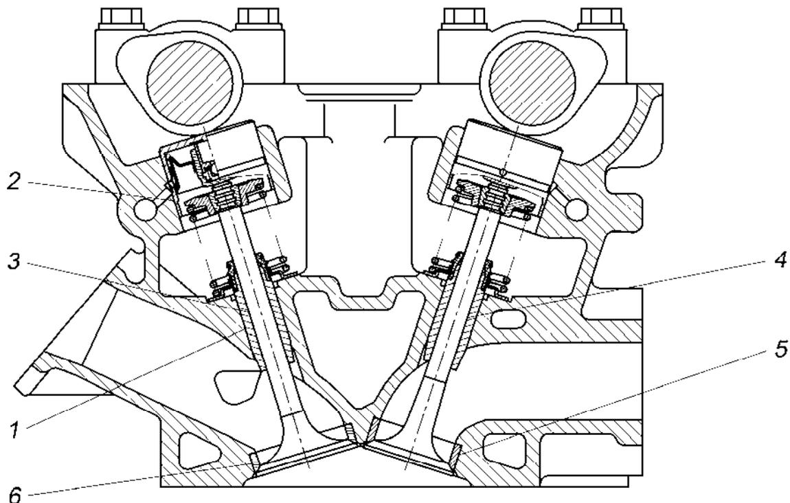
Рис.235. Привод клапанов
