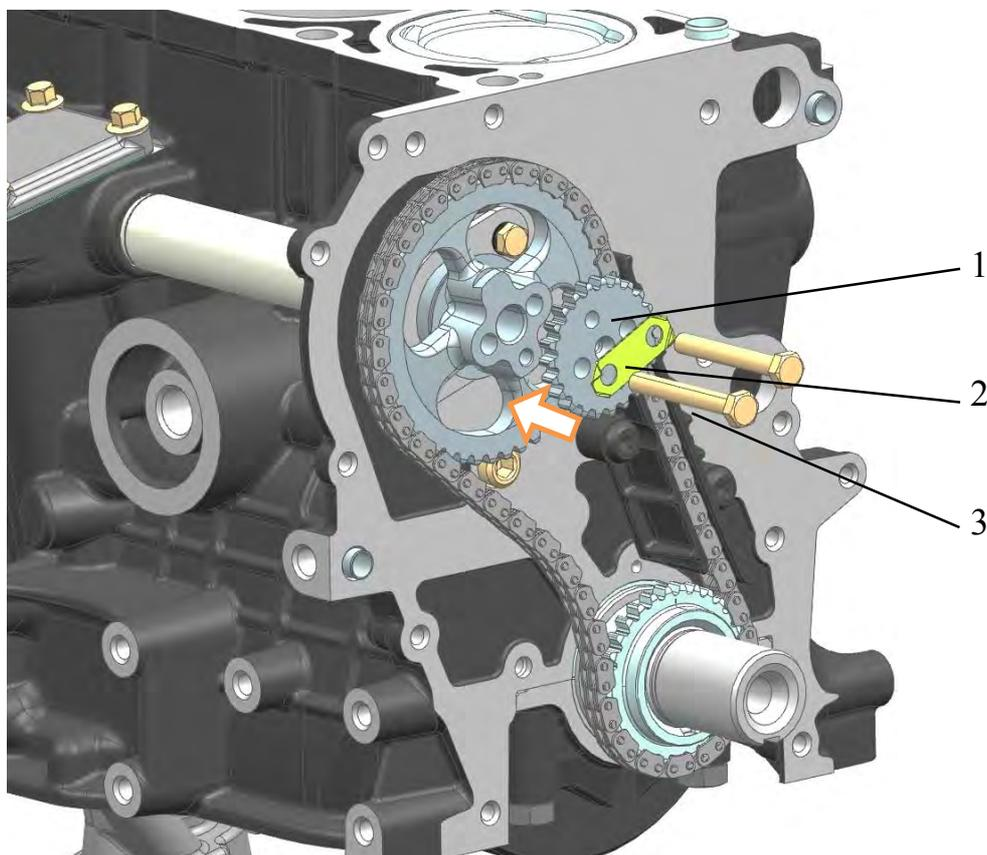
Рис.137. Установка ведущей звездочки промежуточного вала:
