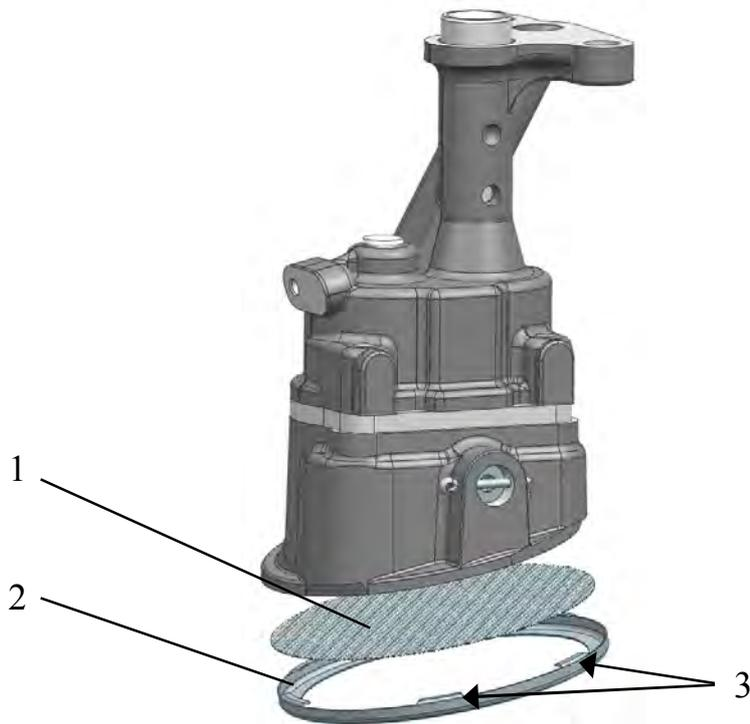
Рис.102. Снятие каркаса с сеткой с приемного патрубка масляного насоса:
