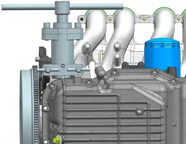
Рис.253. Установка приспособления ЗМ 7823-4815 на двигатель
