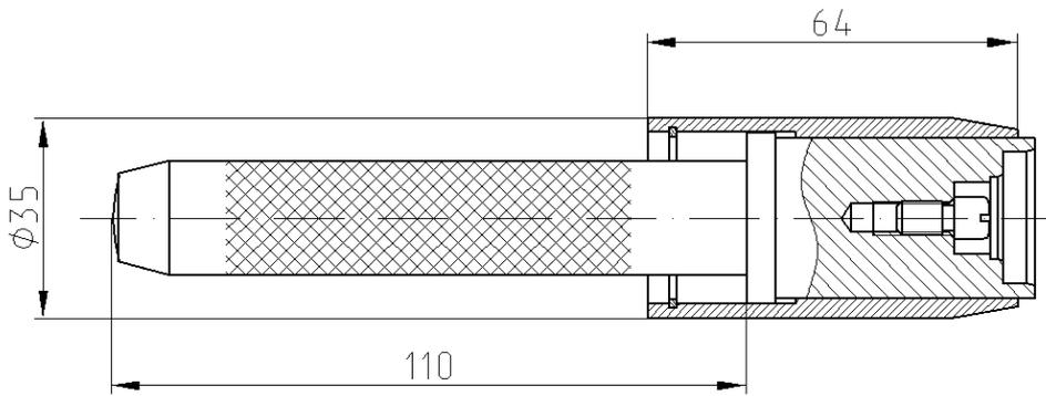
Рис.249. ЗМ 7853-4355, Оправка для напрессовки
