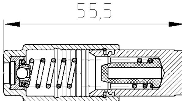
Рис.89. Гидронатяжитель с полностью выдвинутым плунжером
