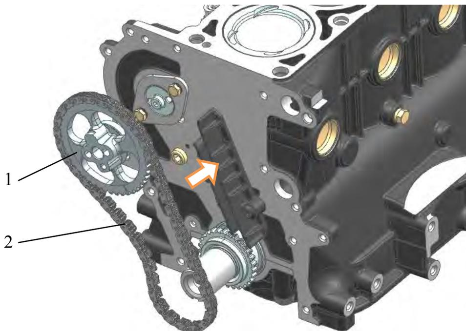
Рис.135. Установка нижней цепи с ведомой звездочкой промежуточного вала:
