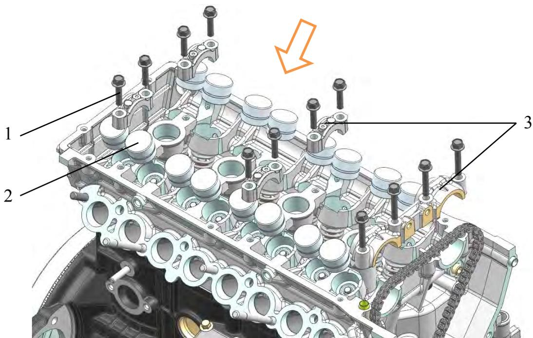
Рис.153. Установка гидротолкателей:
