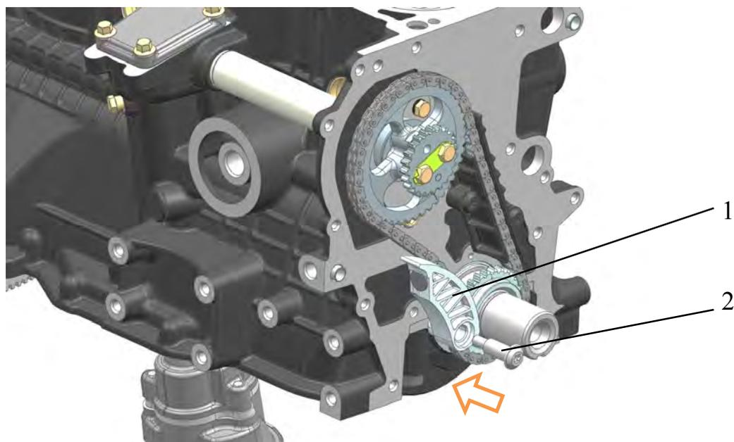
Рис.139. Установка нижнего башмака:
