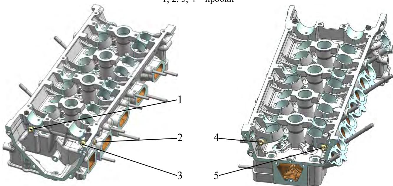
Рис.107. Пробки масляных каналов головки цилиндров:
