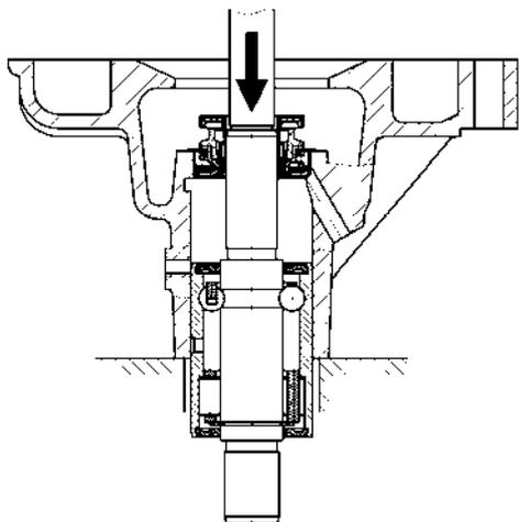
Рис.93. Выпрессовка подшипника с валиком водяного насоса
