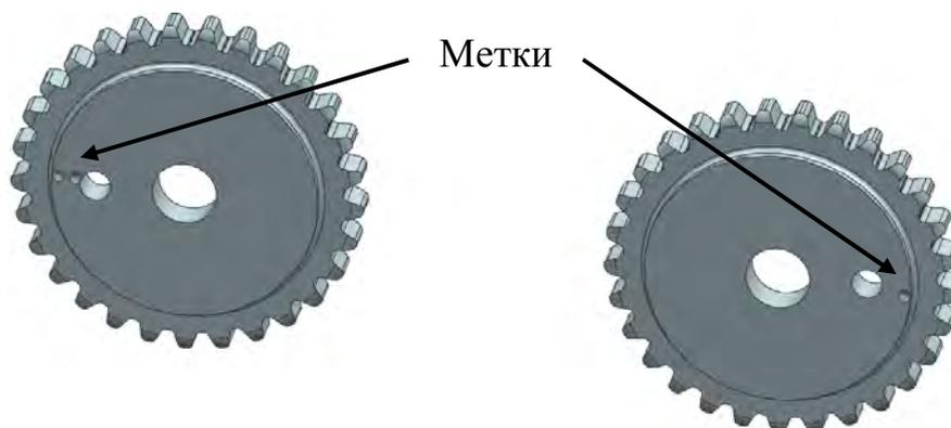
Рис.156. Звездочки распределительных валов
