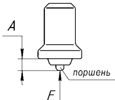
Рис.101. Проверка термосилового датчика
