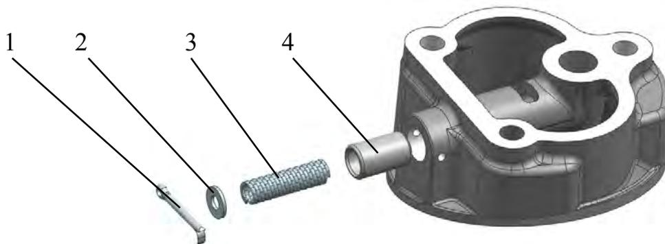
Рис.105. Разборка приёмного патрубка масляного насоса:
