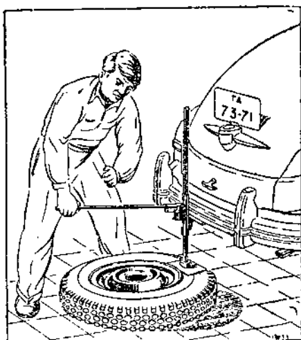
Фиг. 152. Устранение прилипания крышки автомобиля М-72.
