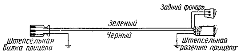
Фиг. 159. Принципиальная схема электрооборудования прицепа ГАЗ-704.
