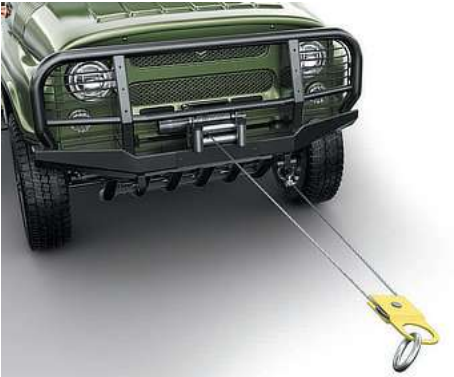
Блок 4 дюйма Благодаря блоку увеличения тягового усилия лебедки нагрузка на нее может достигать 8000 кг.
