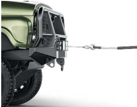
Стропа буксирная динамическая 6 см X 9 м, 8 000 кг Буксировочные стропы из нейлона с большим коэффициентом удлинения позволяют не только буксировать неисправный автомобиль практически без рывков.
