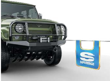
Гаситель троса Гаситель троса — защитная накладка на трос, которую нужно закрепить на нем до того, как к нему прилагается нагрузка. В случае разрыва троса или стропы гаситель примет на себя основную ударную волну.
