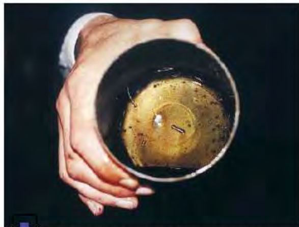
...в его внутренностях обнаруживается «захороненная» стружка
