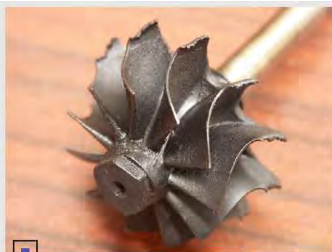
Судя по тому, что повреждены входные кромки турбинного колеса, нечто прилетело из мотора
