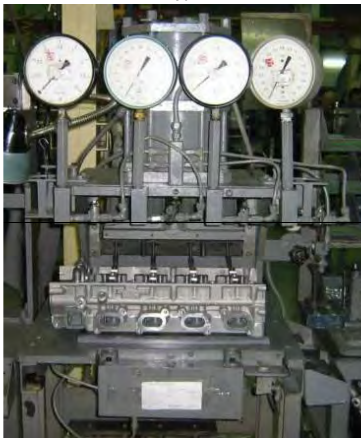
Испытание камер сгорания на герметичность на установке ЗМ 7871-4389
