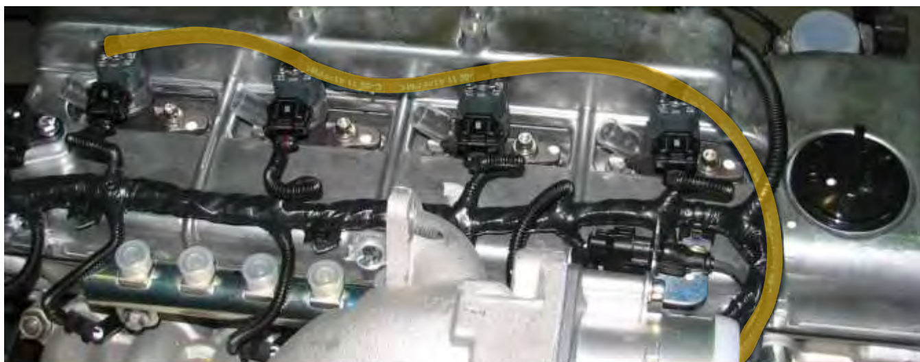
Рис.58. Внешний вид топливопровода отсечного топлива.
