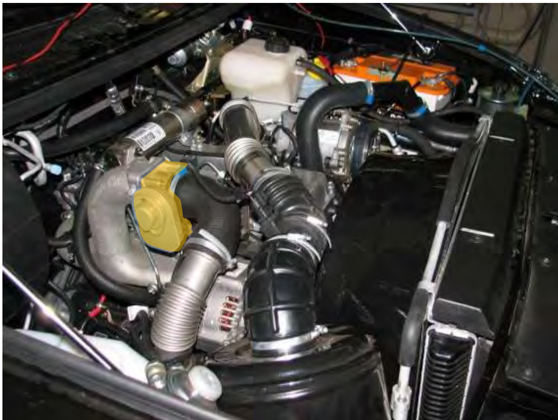
Рис.95. Место установки патрубка с дроссельной заслонкой с электроприводом
