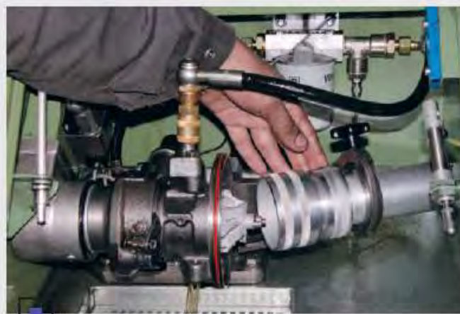
При испытании на стенде Turbotecnics полностью имитируются условия, в которых работает турбина
