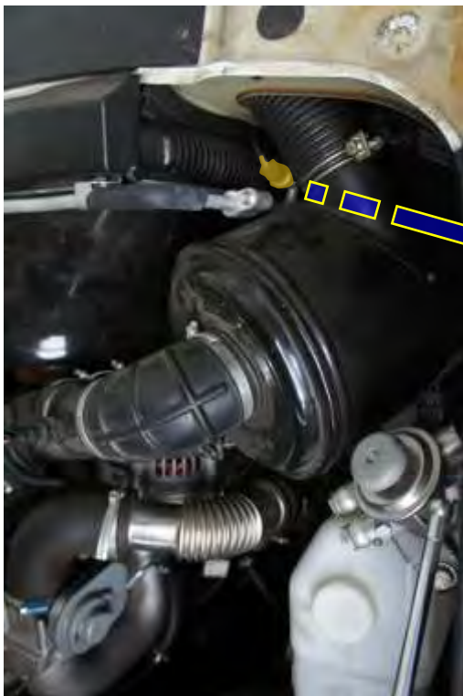
Рис.101. Расположение датчика давления хладагента кондиционера в моторном отсеке автомобилей УАЗ-31638 Патриот, УАЗ-23638 Пикап, УАЗ-23608 Карго.
