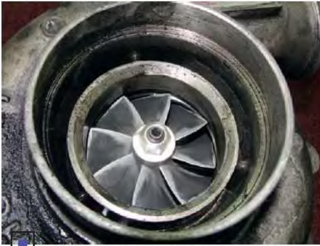
Характерный признак неисправной системы вентиляции картера — черная сажа на крыльчатке компрессора
