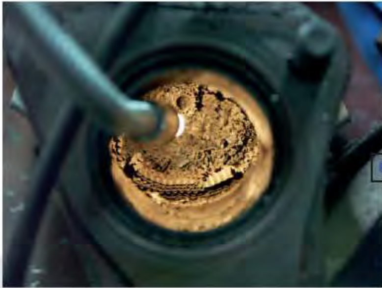
Катализатор «спекся», противодавление в системе выпуска отработавших газов возросло. Турбине плохо, но она не виновна
