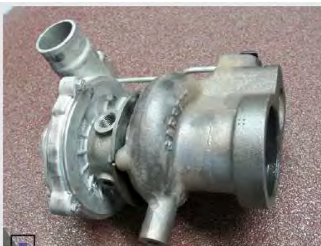
Цвета побежалости на корпусе турбины — признак перегрева. Хорошо виден «удароопасный» алюминиевый опорный диск улитки компрессора
