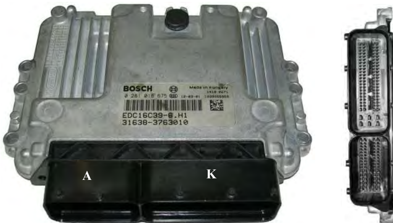
Рис.78. Внешний вид ЭБУ модели EDC16C39-6.H1:
