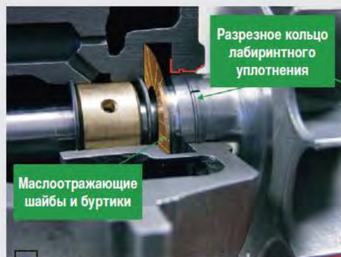
Со стороны компрессора динамическому уплотнению помогают маслоотражающие элементы
