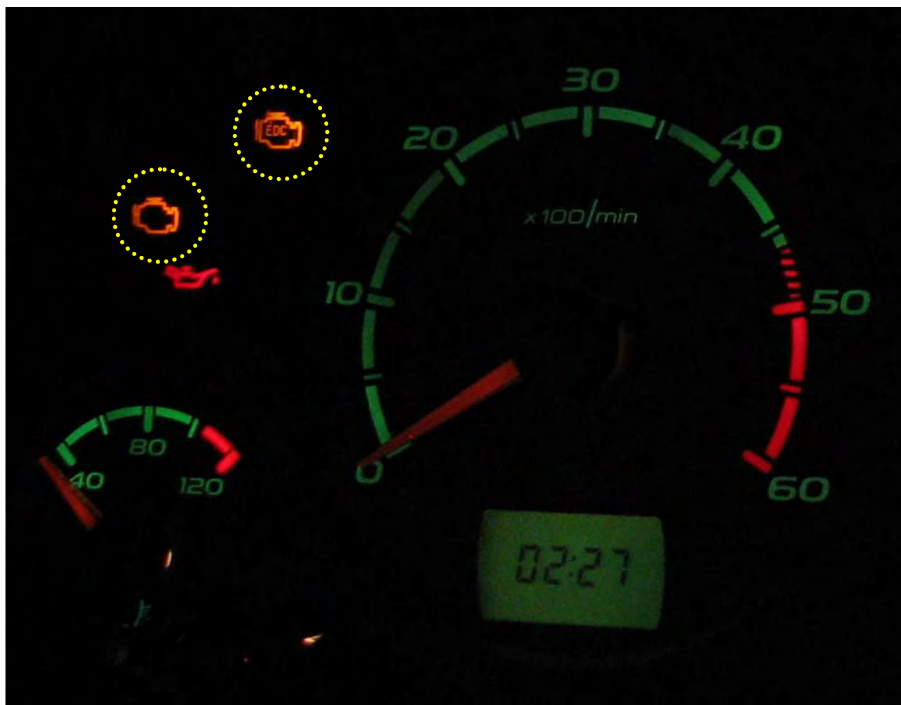
Рис.111. Расположение индикаторов неисправности узлов системы управления двигателем на панели приборов УАЗ-31638 Патриот, УАЗ-23638 Пикап, УАЗ-23608 Карго.
