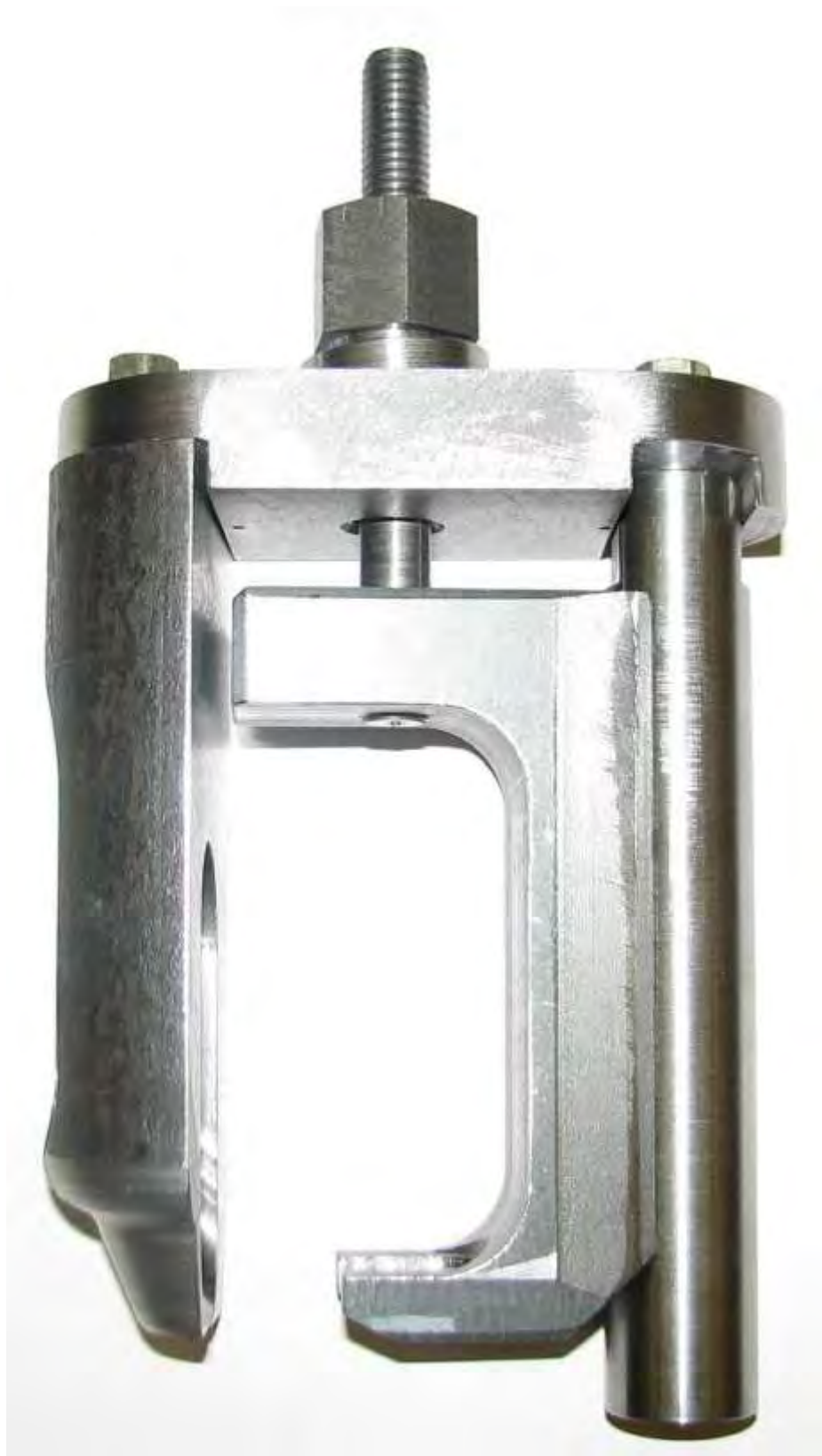
Рис.А.24 – 3М 7823-4832 Съемник для извлечения топливной форсунки из головки цилиндров
