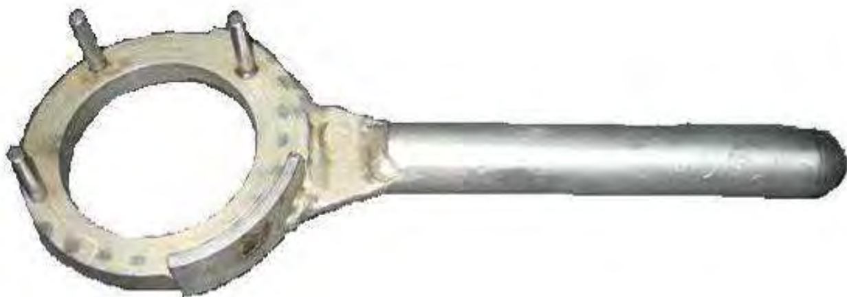
Рис.А.4 – ЗМ 7812-4791 Ключ для проворачивания звездочек распределительных валов
