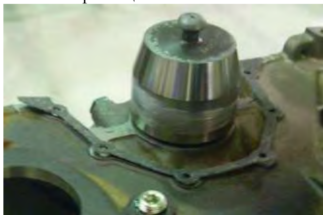
Рис.А.5 – ЗМ 7853-4357 Оправка для установки заднего сальника на фланец коленчатого вала
