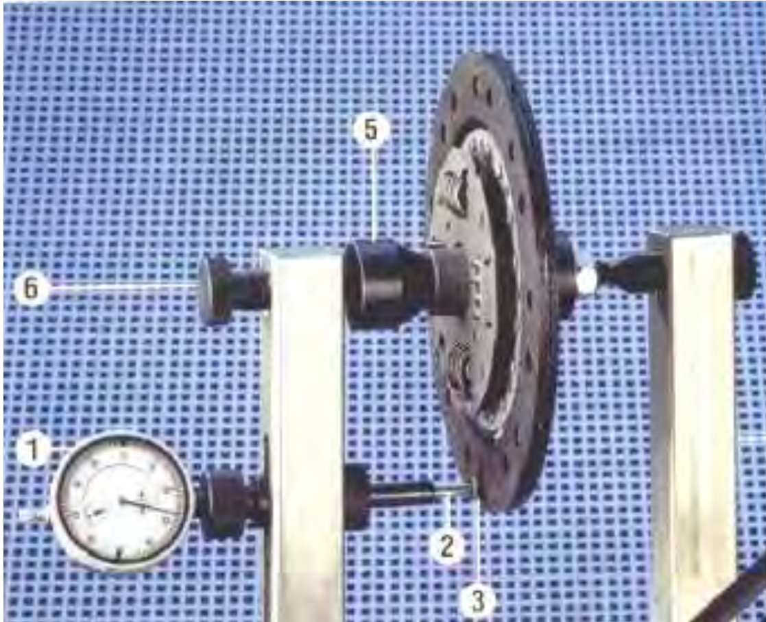
Рис.74. Проверка биения рабочей поверхности ведомого диска.
