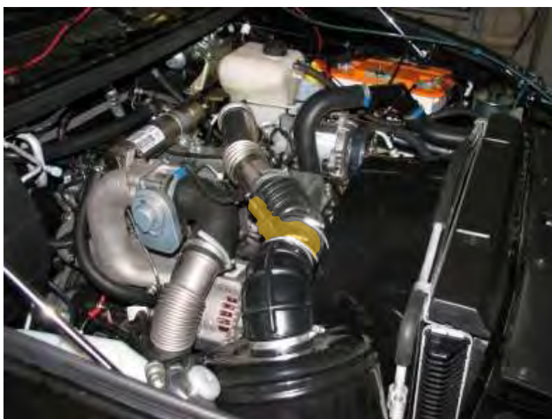
Рис.84. Место размещения ДМРВ в системе впуска
