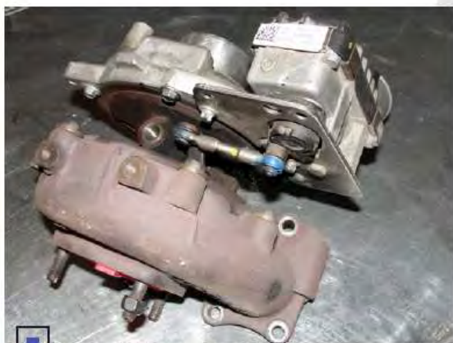
Горячие корпуса бензиновых турбин чаще страдают от трещин
