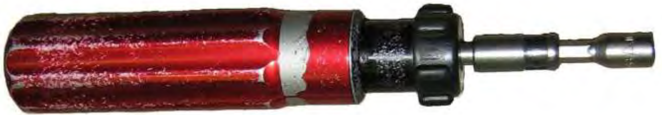
Рис.А.29 – Отвертки 757-06 (момент до 6 Н·м) и 757-07 (момент до 9 Н·м) для затяжки червячных хомутов
