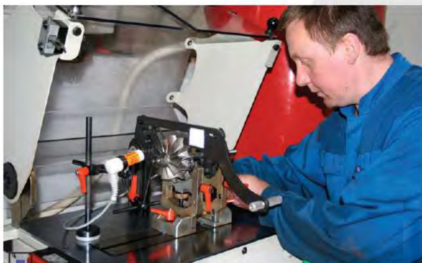
И при производстве, и при восстановительном ремонте детали и сборочные узлы турбин многократно балансируются
