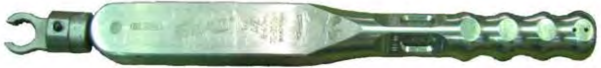
Рис.А.27 – Динамометрический ключ для затяжки гаек топливопроводов высокого давления. Дремометр №7460-01 AZ A+S (0,8-4,0кгсм) Ø 16мм + Вставная накладная насадка с открытым зевом № 8797-17, код 1211706, ф. Gedore.
