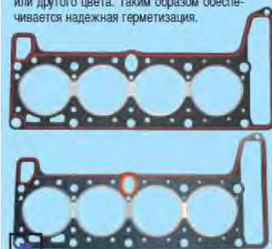
Одна и та же прокладка от разных производителей. Герметик проложен по-разному
